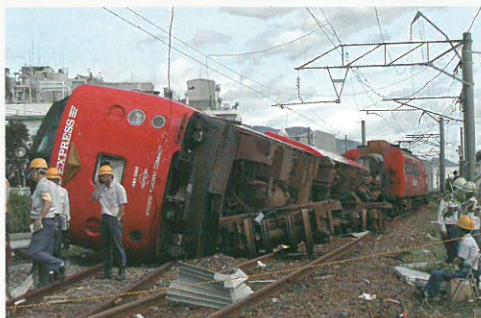
② 台風にもなう竜巻で脱線した鉄道車両(2006年, 宮崎県延岡市)
